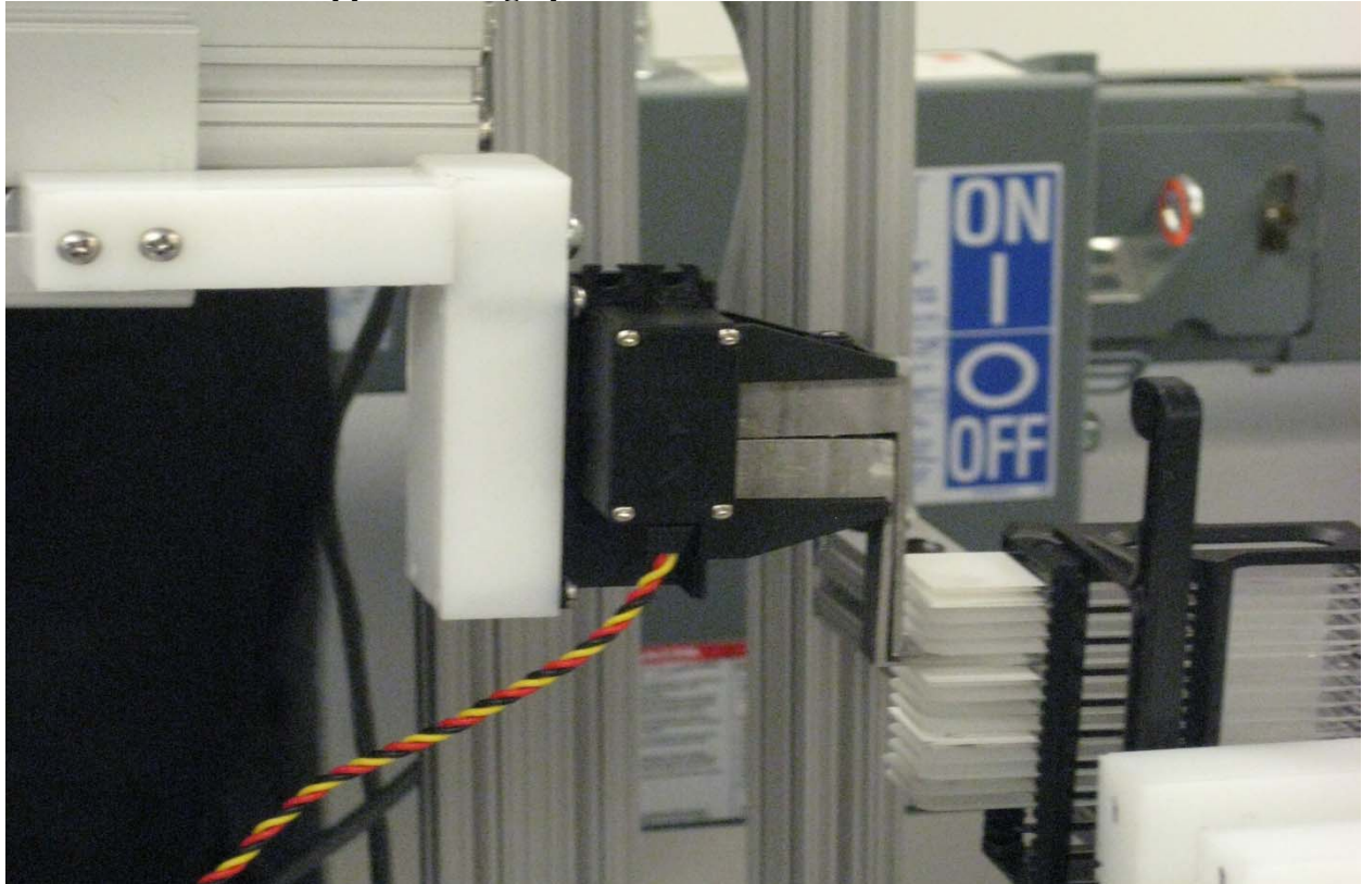
APPENDIX N.16: Another view of gripper picking up slide
