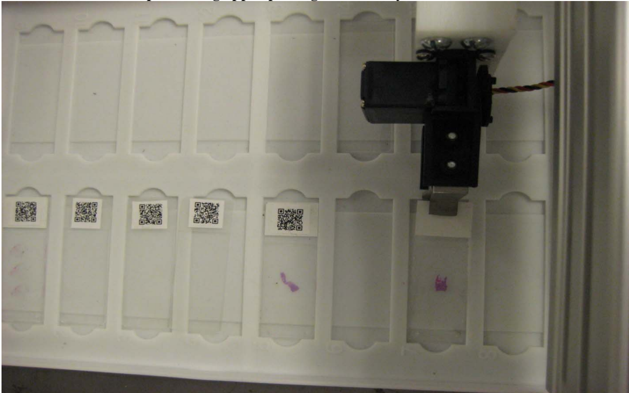
APPENDIX N.18: Top view of gripper placing slide in tray
