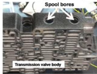
Fig. 4.4 Actual spool bores on a transmission valve body
