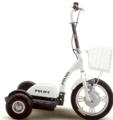
Angell Transporter 350W/36V/21Ah LA 15kph/30km Angell Autocycle Jiangsu
