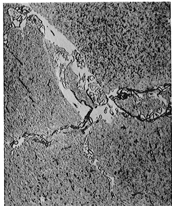
(d) Heat 1333B - 0.0330%S stress - 15,000 psi rupt. time - 450.5 hrs, RA - 12%
