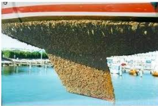
Hull Fouling coatzyme.dk
