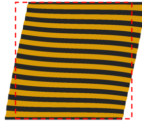
(d) \hat{\Sigma}_{21} = \Sigma applied on a 12 fiber volume element
