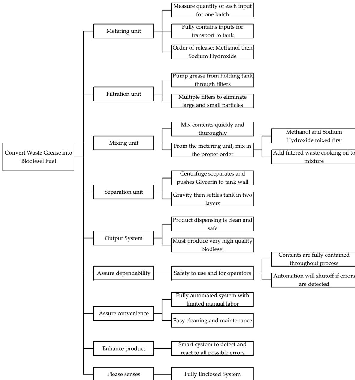
**Figure 3. FAST diagram**
