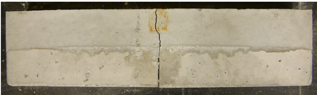
(d) HES-Concrete overlay system (rough interface)
