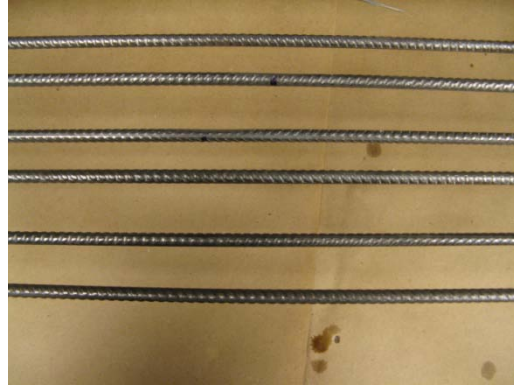
(d) Deformed Wire (D5)
